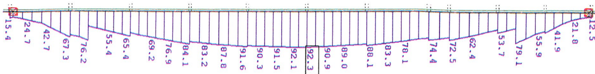
Charakterystyczne wartości naprężenia w włóknach dolnych [MPa] – przekrój niezespolony
